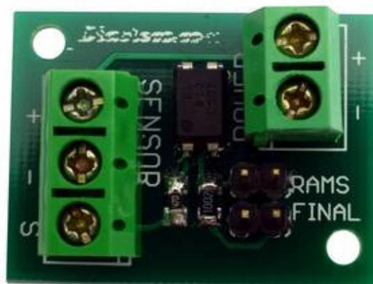
eBACAS (por sus siglas en inglés de *autonivelador capacitivo mejorado de la cama*) sirve para nivelar el eje sobre la cama de tu impresora 3D sin necesidad de contacto físico y que incluye un conector para contacto de seguridad redundante.
